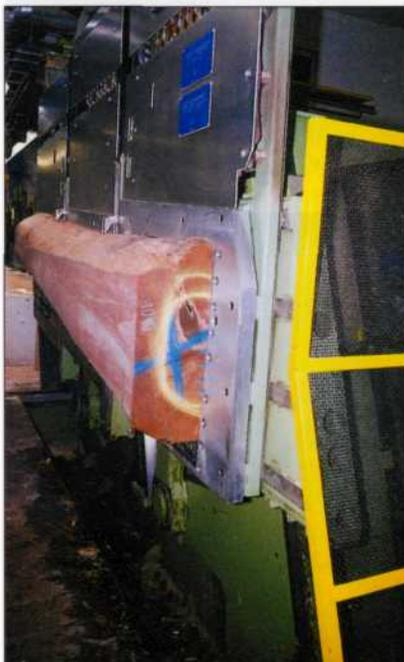
Eingespannter Block auf dem Vakuumtisch, oben sind die rückfahrbaren Greifklauen sichtbar
