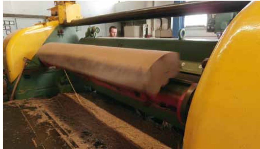
Staylog-Maschine im vollen Einsatz bei der Riffaufarbeitung
