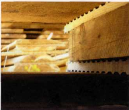
Die profilierten Stapelleisten aus Holz lassen die Luft zirkulieren und zeichnen sich nicht ab
